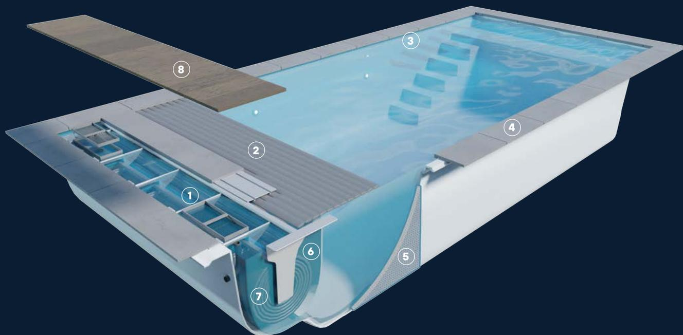
1. **Système d'entraînement en acier inoxydable 316L** avec double skimmer intégré et invisible, à niveau d'eau élevé
